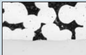
なじみ運転が終わって、ある程度の運転時間経過後の DDK35ドライベアリング断面写真
