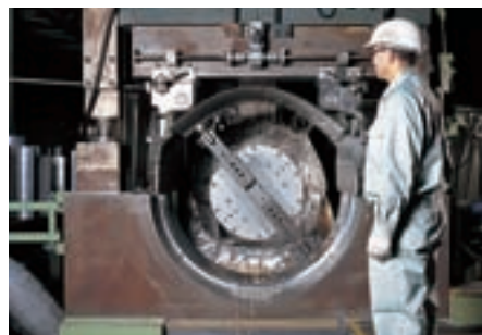
大型内径ボーリング 内径φ1000mm以上も高精度な内径ボーリング加工ができます
